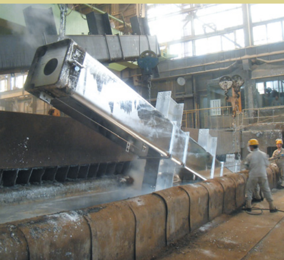
中間検査 Interim inspection めっき状態のチェック
