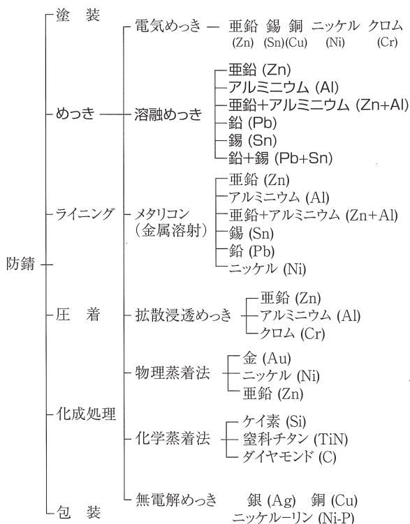
図1 金属の防錆方法
